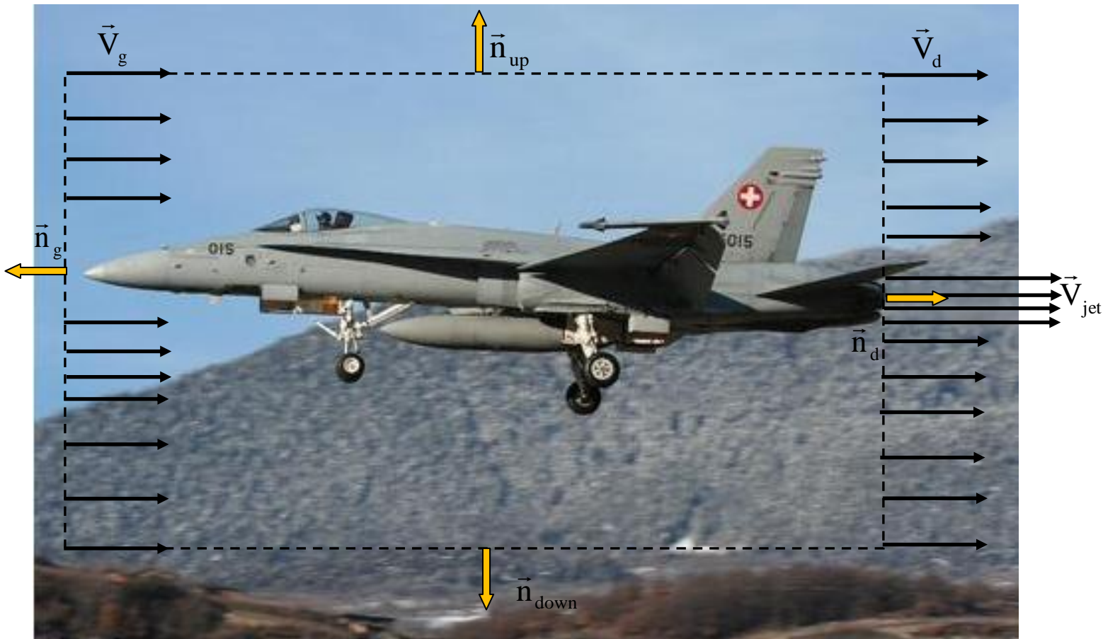
Figure 4 : Volume de contrôle attaché à l'avion
